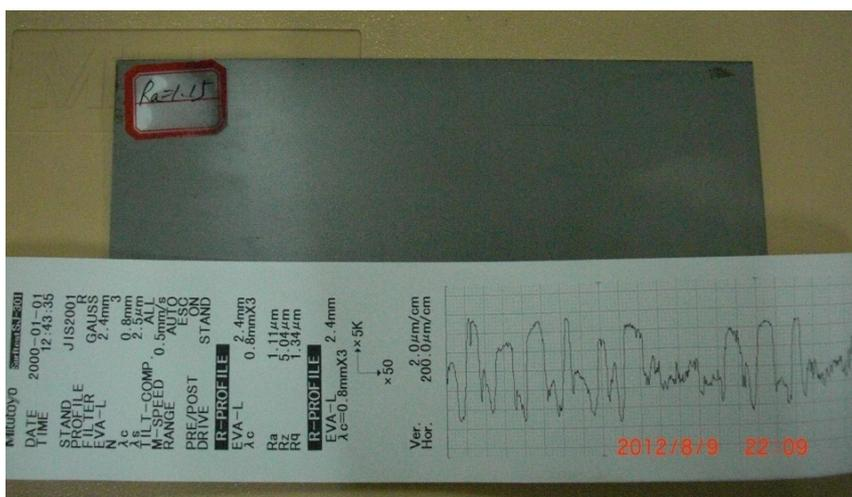
图11. 家电毛化板及表面粗糙度曲线
