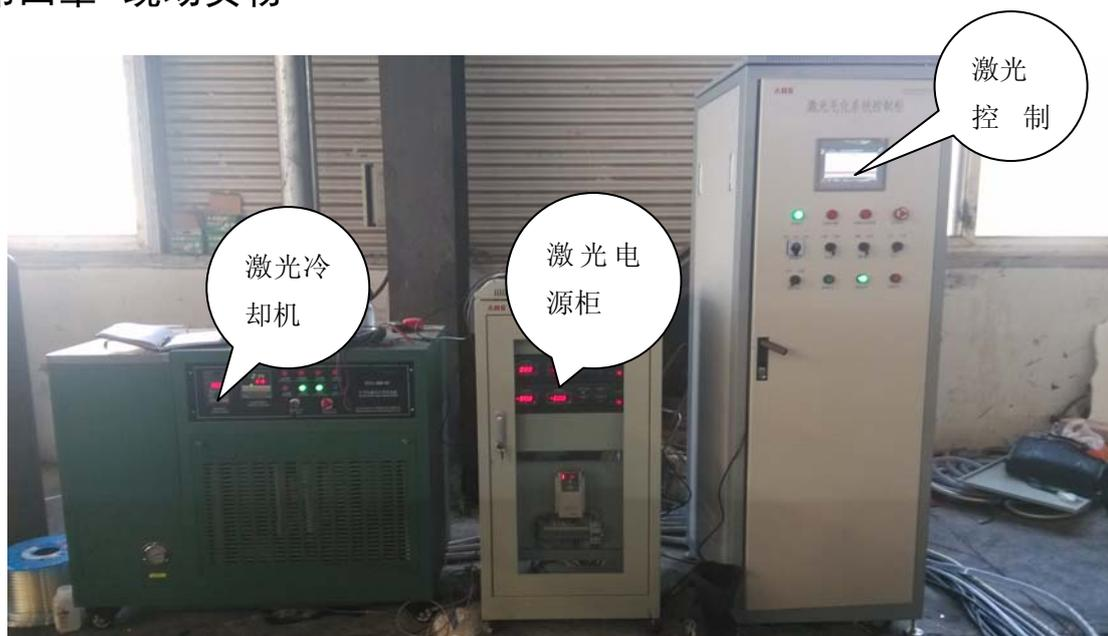
图 13 轧辊毛化机控制系统
