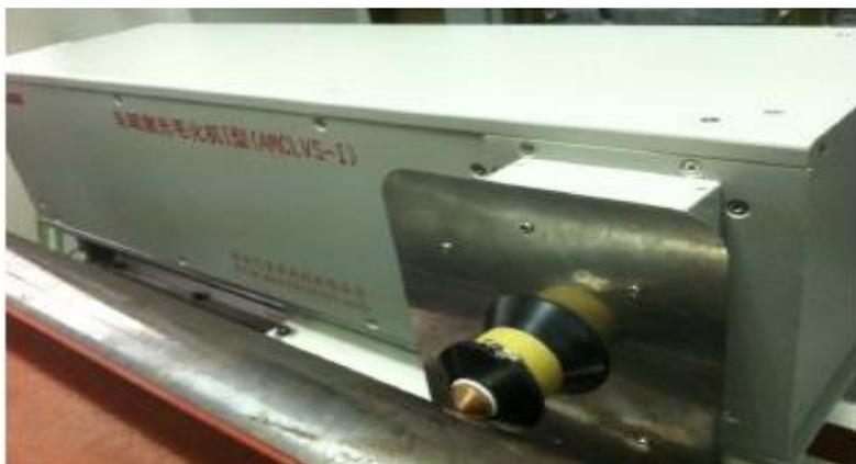
图 3. 脉冲串 YAG 激光器外形
